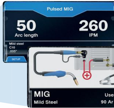
Pantalla de configuración para MIG pulsado
