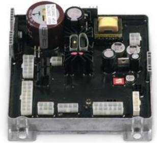
La placa de circuitos impresos encapsulada y en bandeja agrega una confiabilidad excepcional, incluso en los entornos más exigentes. La placa tiene un aislamiento pleno para el gatillo. Un gatillo de la antorcha en corto no afectará la operación del alimentador.
