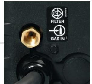
La entrada de gas retrocedida a la parte posterior del estuche está protegida contra el contacto incidental con el cable de soldadura. Esto garantiza un suministro de gas de protección uniforme y libre de contaminantes a la antorcha. La válvula de gas con filtro doble evita la acumulación de suciedad que afectaría el flujo de gas.
